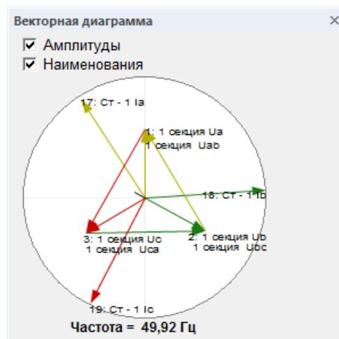
Рис. 10.14 – Векторная диаграмма линейных и фазных напряжений.
